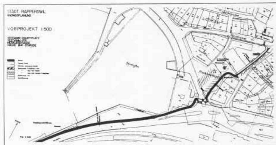
Bild 1. Das Vorprojekt für einen Radweg wurde auf einen Grundbuchplan im Massstab 1:500 gezeichnet. Die Verkleinerung der Vorlage in den Massstab 1:3000 enthält zwar alle Informationen, ist aber unverständlich und somit wertlos.
